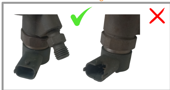
Elektronischer Stecker ok abgebrochener Stecker
