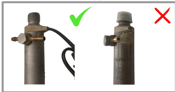
NBF - Nadelhubgeber ok abgetrenntes Kabel
