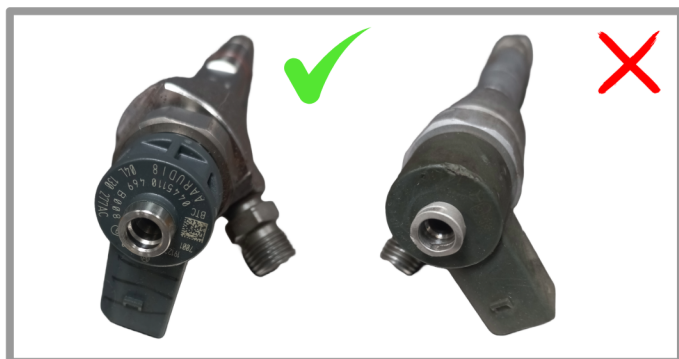
Nadelhubgeberkabel ok gebrochenes Kabel, Isolierung beschädigt
